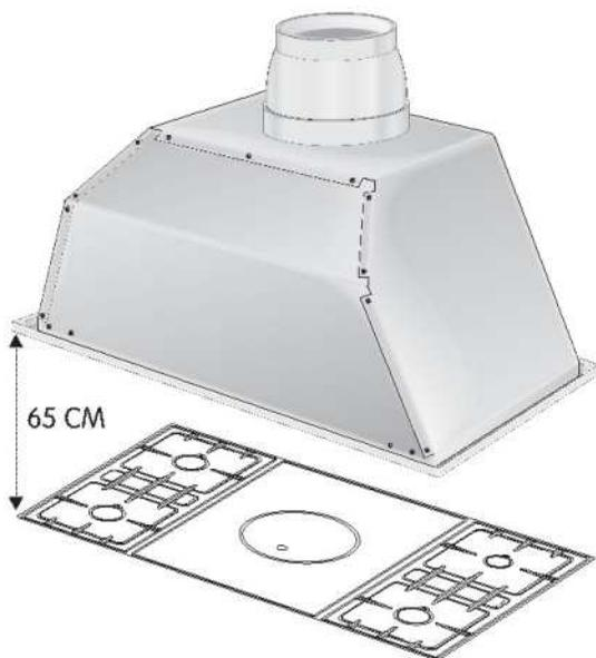
**B - HOW TO POSITION THE HOOD CASING (ASPIRATING TYPE)**
